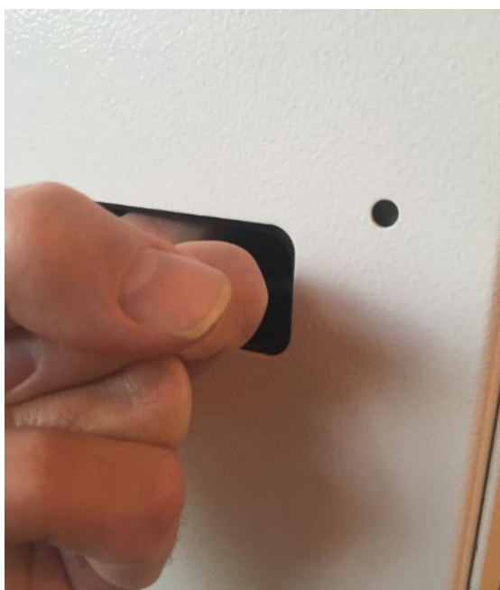
Figur 22: Åpning av døren på serienummer høyere enn DECONX110
