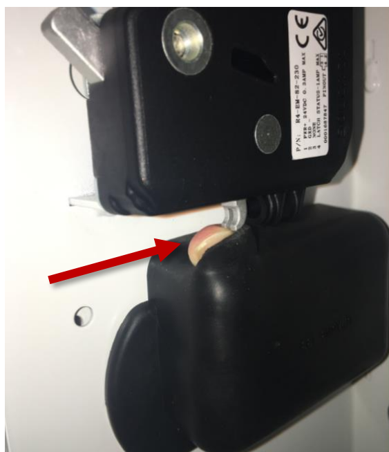
Figur 23: Tuppen av pekefingeren presser metallflippet bakover (i retning den blå pilen) slik det vises fra innsiden av kjemikammeret på DX1.
